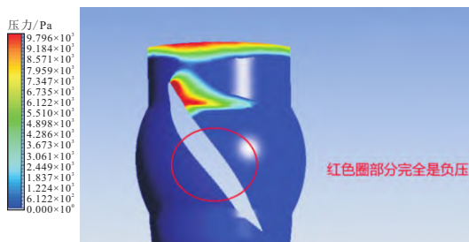
图 8 轮毂周围流场静压分布 CFD 分析结果
